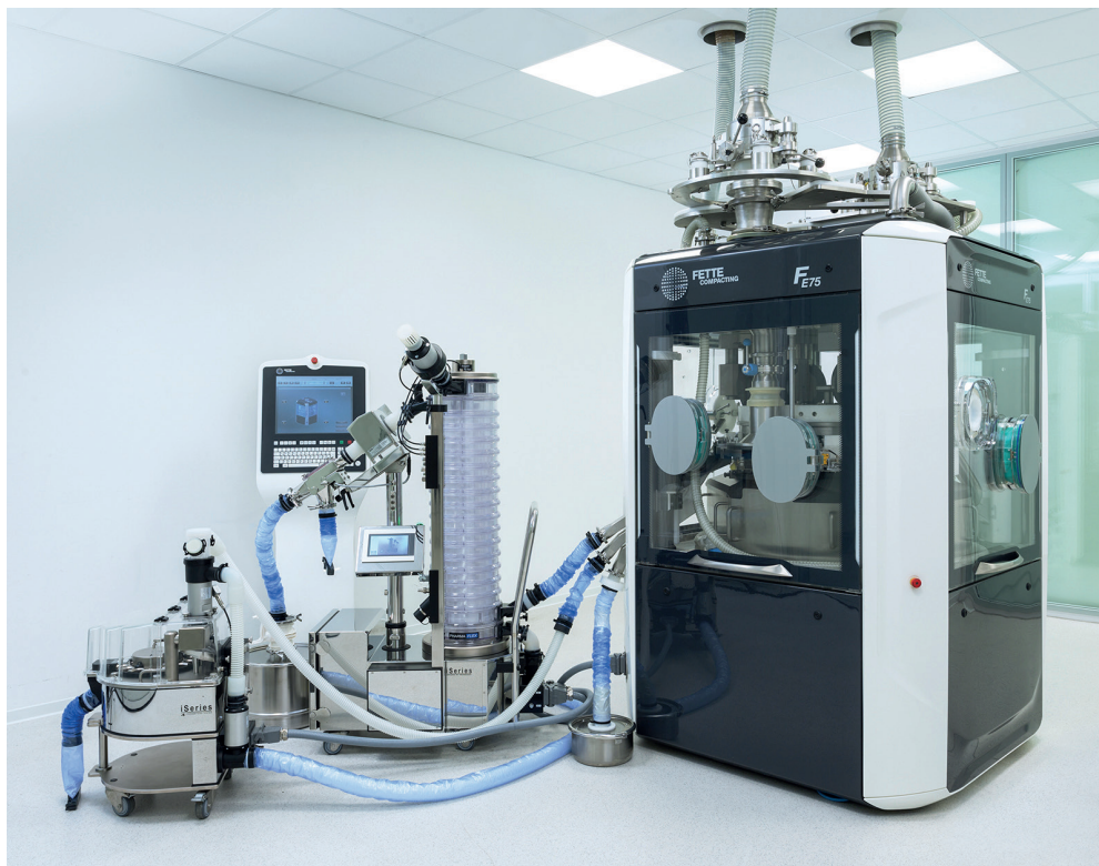
Beispielhafte Containment Guard-Lösung für die staubarme Produktion: Tablettenpresse FE75 mit Containmentpaket und Process Equipment.
