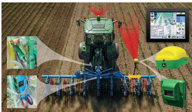
Traktor-Integrierte Aktive Anbaugeräteleitung mit Infield Automatisierung für Hochleistungshacken – AutoTrac Implement Guidance John Deere GmbH & Co. KG, Halle 13, Stand E30 Gemeinschaftsentwicklung mit: MONOSEM (Frankreich), Halle 11, Stand C54
