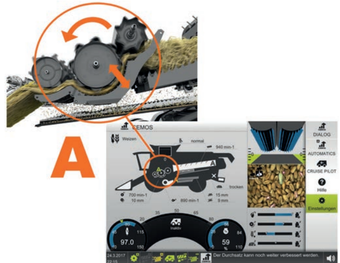
CEMOS AUTO THRESHING - das autonome Dreschwerk für CLAAS Schüttler- und Hybrid-Mähdrescher
