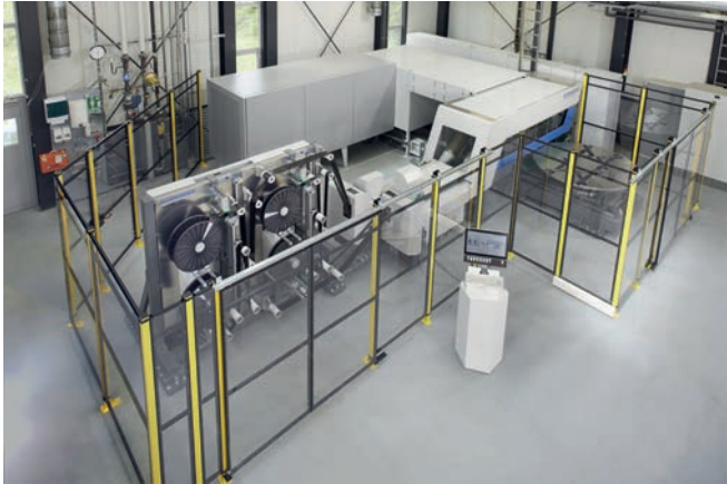
© Foto Fraunhofer ICT Dieffenbacher Fiberforge – Anlage zur voll automatisierten Verarbeitung von unidirektional faserverstärkten Thermoplast-Tapes (UD-Tapes)
