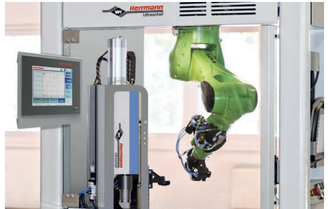
modulare Roboterzelle mit integriertem Ultraschall-Schweißsystem
